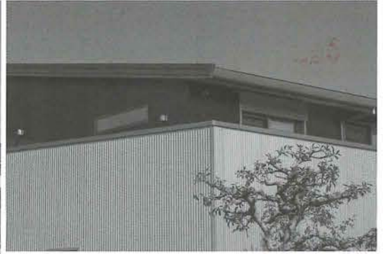
今年3月に福岡県春日市にオープンさせる次世代住宅モデルハウス「棲香(SUMIKA)」。U A 値0.44W/m 2 ・Kの外皮性能を持ち、屋根一体型のPV11.88kWを搭載する。HEMSによるエネルギー管理も可能だ
