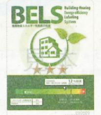
※冷暖房、給湯、換気、照明などの設備機器のエネルギーを熱量換算した合計値。基準値との比較で算出される
